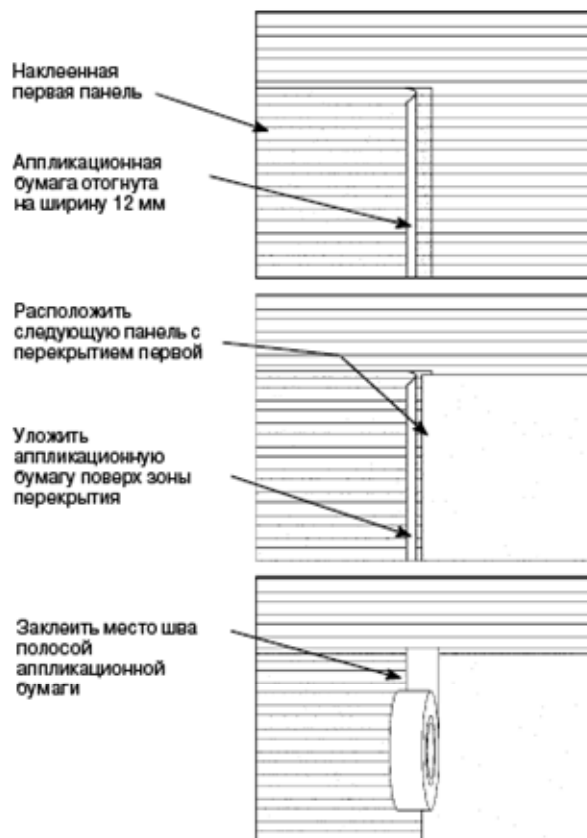
Рис. 24. Наклеивание составной графики
